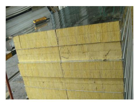
外墙岩棉板的主体材质是玄武岩棉板,玄武岩、铁矿石、铝矾土等为主要原料,经过高温融熔加工加入适量粘结剂成的人工无机纤维,具有质量轻、导热系数小、吸热、不燃的特点。外墙岩棉板性能介绍外墙岩棉板是在岩棉板的基础上增加了水泥砂浆抹面,加固了岩棉板的硬度,直接省去了施工时上墙抹灰的过程,使岩棉板在安装使用中工期缩短70%,岩棉板是以玄武岩及其它天然矿石等为主要原料,岩棉板经高温熔融成纤,加入适量粘结剂,固化加工而制成的。岩棉板产品适用于工业设备、建筑、船舶的绝热、隔音等。
